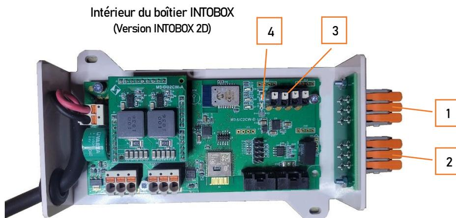
1. Prévoir l'alimentation secteur 220V de l'INTOBOX par un câble 3G1.5mm<sup>2</sup> protégé par un disjoncteur P+N 230V/6A. Il est possible d'insérer un interrupteur mural dans le circuit d'alimentation secteur pour allumer/éteindre l'éclairage
