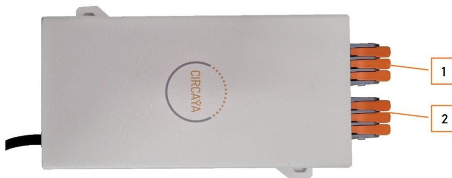
1. Prévoir l'alimentation secteur 220V de l'INTOBOX par un câble 3G1.5mm<sup>2</sup> protégé par un disjoncteur P+N 230V/6A. Il est possible d'insérer un interrupteur mural dans le circuit d'alimentation secteur pour allumer/éteindre l'éclairage
